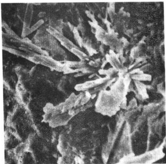
IV 1 下青山灰白色粘土砾石层风化壳,经间冰期 湿热化及在高能化学环境下,在石英砂表面 的凹坑中形成重结晶的石膏晶族。×1800
